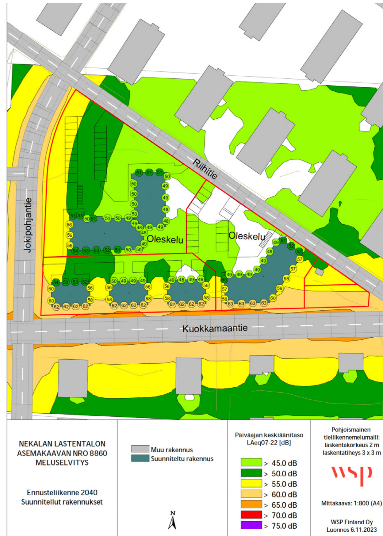
Ote Nekalan lastentalon meluselvityksestä (Wsp). Kuvassa havainnollistettu 2040 vuodelle ennustetun liikenteen meluvaikutuksia päiväaikaan suunnitelluilla rakennusmassoilla
